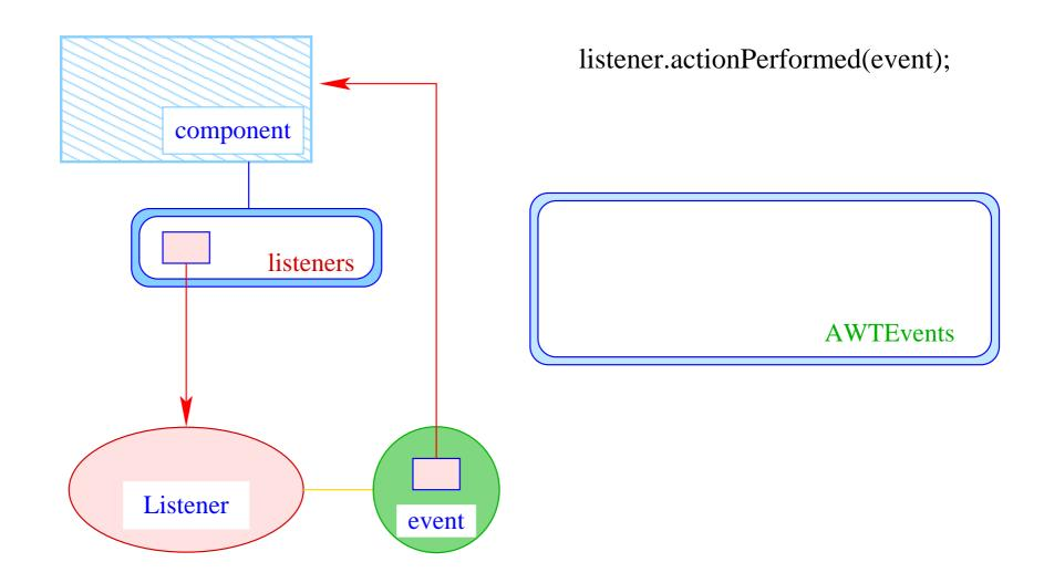
• Jedes AWTEvent-Objekt verfügt über eine Quelle, d.h. eine Komponente, die dieses Ereignis erzeugte.
